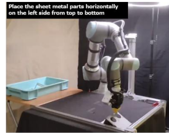
ルールベース+VLAのハイブリッド構成でのデモ (板金上下整列: 成功率85%, 板金左右整列: 成功率80%)
