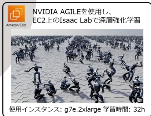
報酬関数設計やランダムマイゼーションを行い、しゃがみ動作、前傾動作の独自ポリシーを実現した。
